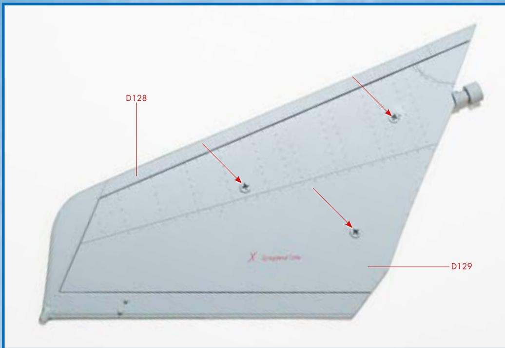
**1** На этом этапе сборки вам потребуются детали, полученные с этим номером, и узел деталей из №111. Соедините верхнюю часть стабилизатора (D128) и нижнюю часть стабилизатора (D129), как показано на снимке, и зафиксируйте детали винтами SM.
