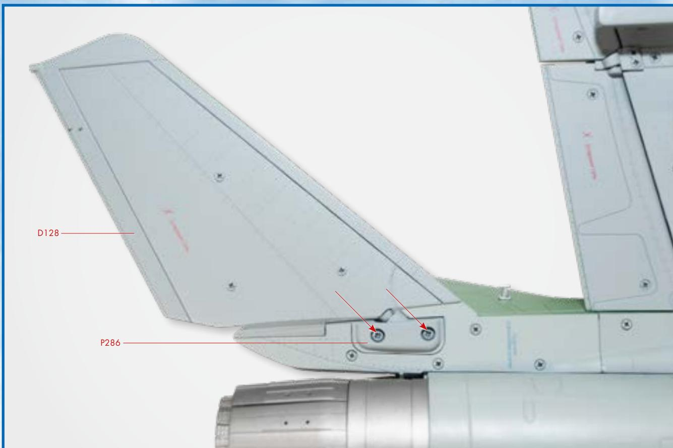
**2** Вставьте ось стабилизатора в гнездо фюзеляжа, затем установите крепежную планку (P286), как показано на снимке, и зафиксируйте ее винтами LM. Проверьте подвижность стабилизатора.
